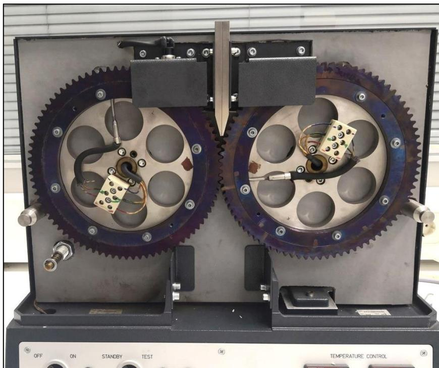
**Fotografía 6.** Onduladora con rodillos onda A/C
